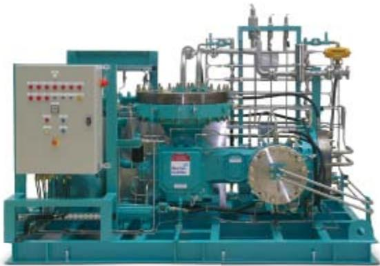
**Membrankompressoren:** Howden Metall-Membran-kompressoren bieten eine kontaminationsfreie, leckagefreie Verdichtung jeglicher Gase. Dies ist der ideale Kompressor für Anwendungen, welche nach hoher Gasreinheit und/oder Schutz der Umgebung verlangen. Howden Membrankompressoren sind auch die perfekte Lösung für stark reaktionsfreudige und korrosive Gase sowie für Anwendungen welche nach eine zuverlässigen ölfreien Verdichterlösung bei hohem Kompressionsverhältnis verlangen.
