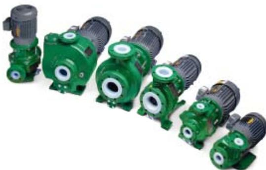
Die Sundyne ANSIMAG dichtungslose magnetgekuppelte nichtmetallische Produktlinie zeichnet sich durch einfaches Design mit wenigen Bauteilen aus. Alle medienberührten Teile sind geformte ETFE Komponenten, durch dieses Material wird ein weiter Bereich von korrosiven Flüssigkeiten bis zu 121°C abgedeckt.
