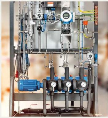
Zur Gewährleistung einer konstanten Qualität des Endproduktes im Extrusionsprozess ist die Treibmitteldosierung von großer Bedeutung. Die LEWA Testanlage wurde für alle bekannten Treibmittel konzipiert, inkl. einer Kühleinrichtung für  ${\rm CO_2}$  und einer explosionsgeschützten Ausführung für brennbare Treibmittel.
